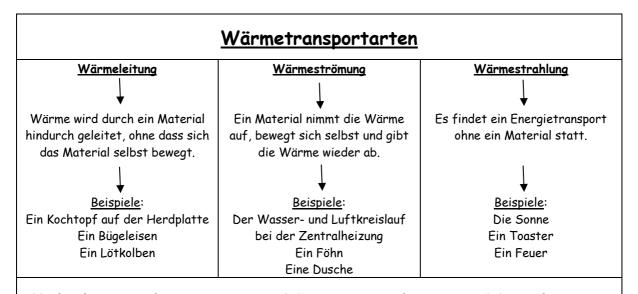
Verhindert man den Transport von Wärme, so spricht man von Wärmedämmung. Ein gutes Beispiel dafür ist die Isolierkanne.
